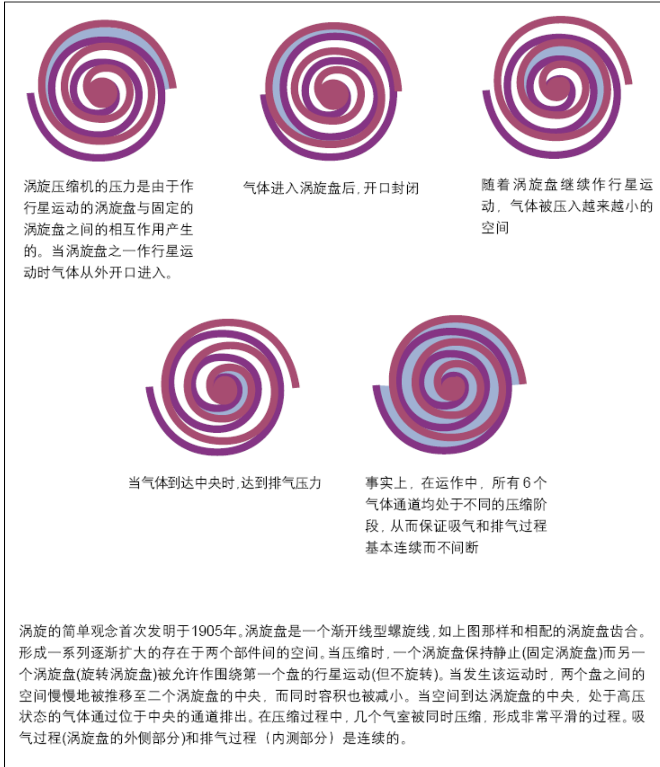
图 1 涡旋压缩机的工作原理
